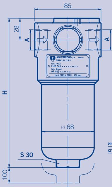
Места установки индикатора и перепускного клапана взаимозаменяемы
