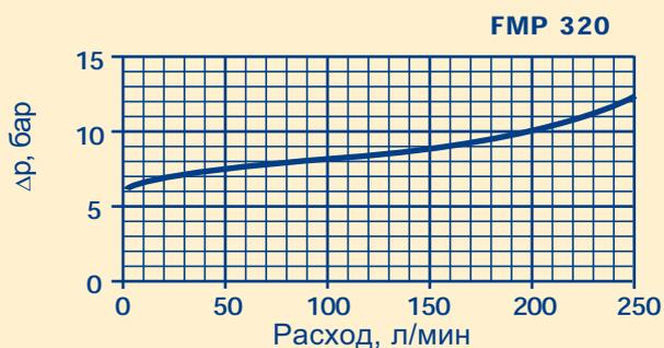
Зависимость потерь давления от расхода для клапана реверсивного потока
