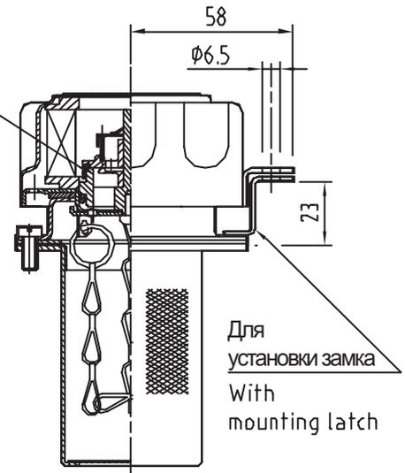
Резьбовое соединение - THREAD CONNECTION
